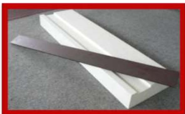
Odrázové břevno pro skok daleký je zhotoveno ze smrkového dřeva, horní strana břevna po 20 cm opatřena výřezem šířky 10 cm a hlubokým 0,7 cm, rozměry -122x34x10 cm, břevno se ukládá do základového rámu, tuhá deska se ukládá do výřezu rozběhové dráhy na straně odrazového břevna přivrácené k doskočišti, její povrch se z úrovně odrazového břevna ve směru rozběhu zvedá o 0,7 cm, do vzniklého trojúhelníku od strany rozběžiště se vkládá plastelína se sklonem 30°, dle norem IAAF **Kód: A3016**
